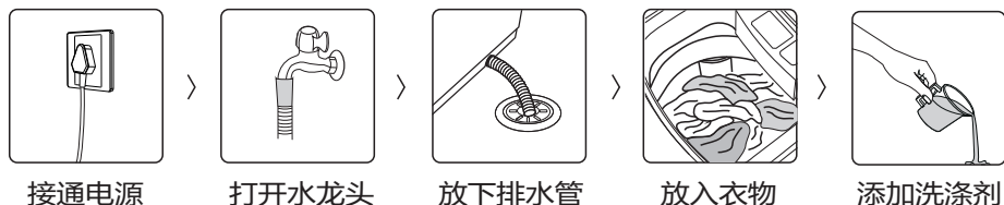
接通电源 打开水龙头 放下排水管 放入衣物 添加洗涤剂
