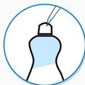
①首次使用，拧开刷头后在密封盖上开一个直径约2mm的小孔，然后轻轻拧紧刷头。
