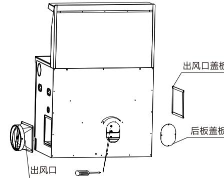
1、先用十字螺丝刀拆卸下后板盖板和风道盖板。
