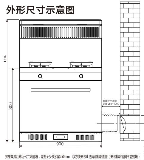
如果集成灶靠近公共烟道墙，需要至少多预留250mm，以方便安装止逆和排烟管（安装排烟管侧不能贴墙）
