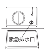
2.向左或向右旋转90° 拉出紧急排水管,拔下紧急排水导管盖
