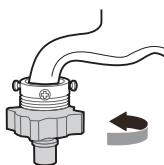
5 下压进水管滑套，将进水管插入连接座。
