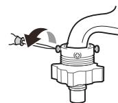
4 逆时针旋紧紧固螺母，以防水龙头漏水。
