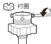
3 连接座对准水龙头中心，将螺钉锁紧在水龙头上。
