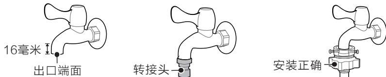
**备注：**不要直接在洗衣机专用水龙头的转接头上安装连接座。如果用户已有洗衣机专用水龙头，为防止脱落漏水，请拧下转接头后，再按照下一页中正确的方式连接进水管与水龙头。
