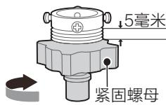
2 旋松四颗螺钉，如水龙头口径偏大可将衬圈取下。
