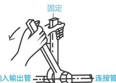
备注: 根据空调标准GB4706.32要求, 其安装方式与普通连接头一样。但该接头一旦被安装后就不能进行拆卸。
