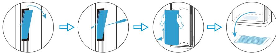
将滤尘网清洗干净，放置在阴凉处晾干
