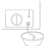
3 拔下紧急排水管盖，并将污水排出
