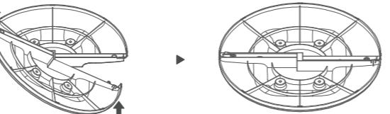
2 将四颗螺钉从机体上拆下然后把底座结合线对准扇体结合线后装到机器上，接着用螺钉将底座与扇体固定并拧紧。
