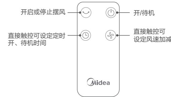
备注：遥控器纽扣电池更换可按遥控器背面图案操作。
