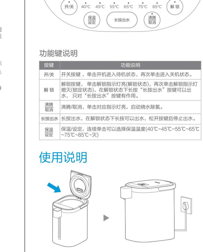
向瓶内加水,关闭上盖,接通电源。
