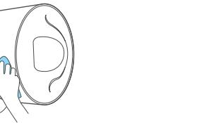
用湿布蘸取少量中性清洗剂轻轻擦拭，不要使用汽油、酒精或酸性溶液等化学溶剂。最后用干布擦干，保持电热水器干燥。
