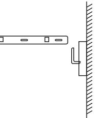
2 先将管线机用PE管连接到净水机上，再按步骤安装在挂钩上（PE管应使用随产品附带的新管，旧软管组件不能重复使用，原水压力0.1-0.4MPa）。
