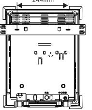
2 先将整机用螺钉固定好（注意水平位置），将管线机用PE管连接到净水机上（PE管应使用随产品附带的新管，旧软管组件不能重复使用，源水压0.1~0.4Mpa）。
