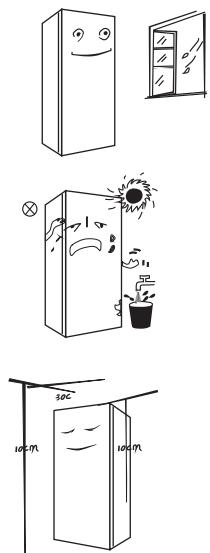
将冷柜放置在室内通风良好的地方，地面平坦、坚固（如有不平稳，可向左或向右旋转调平脚调平）。
