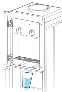
冷排水（带制冷功能水机）
