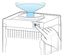
2. 用接水容器接水，**顺时针**转动热水旋钮，即可出热水，**反向**旋转旋钮即可停止出热水。
