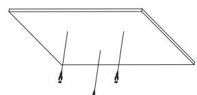
2) 将电源线穿过电源线孔，用螺钉将底盘固定在天花板上，然后按标识接好电源线，注意必须连接接地线，且保证接地可靠，确定无误后通电试灯。
