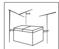
冷柜顶部空间大于70cm，两侧及背部与墙的距离大于20cm，便于冷柜门的开合和热量散发，用温湿抹布将冷柜内外擦干净（温水中可加少量洗涤剂，最后用清水擦净）。
