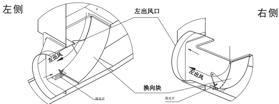
左出风时：把左右位置的固定片螺丝拧下来，换向块位置转到如上图，把左右固定片压住换向块的上方，再用手紧螺丝拧紧。
