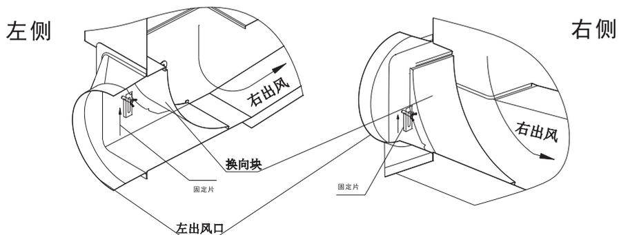
右出风时：把左右位置的固定片螺丝拧下来，换向块位置转到如上图，把左右固定片侧边卡住换向块的缺口上，再用手紧螺丝拧紧。
