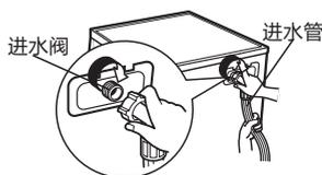
注意：1.安装完毕后，打开水龙头，检查是否漏水。
