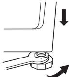
注意:调平洗衣机可以减少噪音和震动，请务必在使用前将洗衣机调平。
