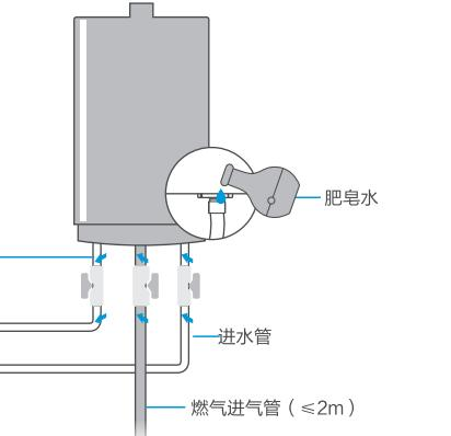
经常(一般半年左右)检查供气管道(橡胶软管)是否完好, 有无老化、裂纹。注意定期更换橡胶软管, 请经常用肥皂水在管路接口处检查有无气泡出现, 判断是否漏气, 若有漏气现象应立即解决。
