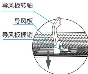
按拆下的反向顺序装好导风板并长按“^”“√”键1秒关闭导风板
