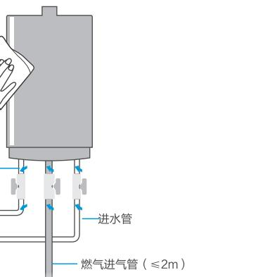
经常（一般半年左右）用柔软的清洁布擦拭机器外壳，可用清水和中性洗涤剂擦拭，禁止使用化学清洁剂或挥发性溶剂，否则外壳褪色并失去光泽。
