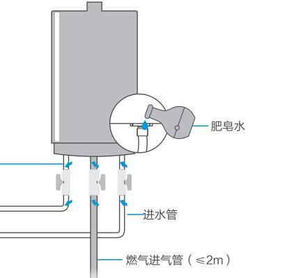
经常（一般半年左右）检查供气管道（橡胶软管）是否完好，有无老化、裂纹。注意定期更换橡胶软管，请经常用肥皂水在管路接口处检查有无气泡出现，判断是否漏气，若有漏气现象应立即解决。
