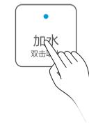
① 系统处于待机状态且未加热时，双击[加水]键可开启取水功能；
