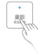
① 接通电源后，所有指示灯闪烁3次，同时蜂鸣3声后，系统处于童锁状态。
