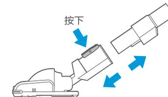
2. 向上提起滚刷压盖拆卸按钮后取出滚刷进行清洁，清洁完毕后按照拆卸步骤装回。
