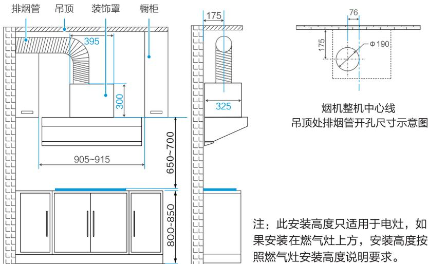
排风管走橱柜安装示意图
