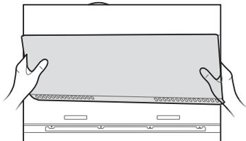
2 拆除下玻璃面板螺钉，将下玻璃面板往上提并取出（取出过程中拔掉照明灯线）
