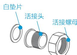
将过滤器摆正连接到管道上，请勿漏装活接螺母里的白垫片。
