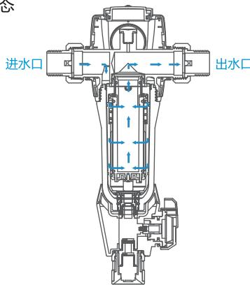
说明：原水由进水口进入过滤器，经过钢丝网内芯时，大颗粒杂质被拦截在钢网外表面，过滤后的水由出水口到后级水管。
