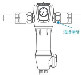
缓慢打开进水阀门，待家用水设备能出水后，再关闭出水口。注意查看前置过滤器各部分连接位置是否漏水或缓慢渗水，同时多次打开关闭排水旋钮排除本机内部空气（10次左右），并查看有无漏水。若有漏水，查看连接位置是否拧紧，建议观察时间为5分钟。
