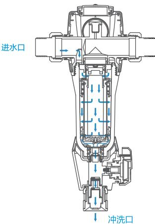
说明：打开排水旋钮，原水由进水口进入过滤器，冲刷钢网外表面，由排污口带走杂质。
