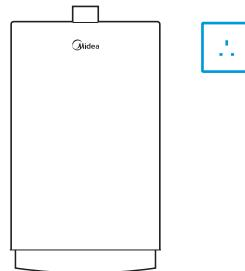
**!** 热水器侧上方安装一个单相三极电源插座，电源插座必须可靠接地，电源插头、插座应通过CCC认证；热水器安装前，如检测到用户家电源地线带电，在未纠正前，禁止进行安装。
