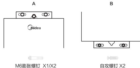
**!** 用户可根据各机型的实际情况选择用A/B两种安装方式中的一种
