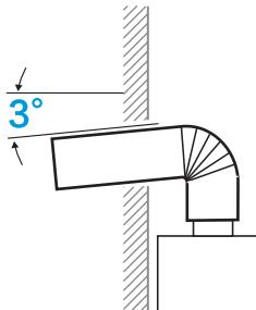
**!** 在热水器附近开一个稍大于排烟管直径的通孔（高于热水器顶部），排烟管伸出房屋外，室外一端稍向下倾斜3°，排烟管与热水器排烟口处用螺钉紧固，不得让废气排到室内，排烟管最后一个孔到墙壁距离≥20cm
