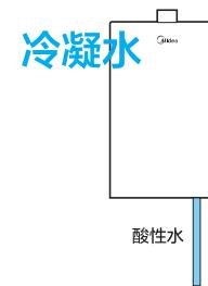
⚠ 冷凝式热水器请按照要求连接排水管，冷凝水中和稀释后才能排入下水道。必须保持冷凝排水管排水通畅，经常检查是否堵塞。冷凝式热水器正常工作时会有冷凝水从排水管流出，属正常现象。冷凝水为酸性，不能作为一般用水，更不能饮用
