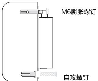
● 挂热水器时保持垂直，按上图所示，在墙体上打好安装孔，上方的安装孔打入膨胀螺钉固定，下方的安装孔塞入塑料塞，拧上自攻螺钉，对墙体、地面实施钻孔前，如属于暗线、暗管且不能明确电线、水管、气管等位置时，必须和用户确认，确保避开墙内埋设的电线、水管或气管。安装的墙体若是空心砖墙，必须采取加固措施，否则禁止安装。
