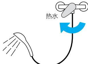
4 旋下安全阀，排完水后旋上安全阀，关闭出热水阀；安全阀内有橡胶垫圈，旋动时请适当大力一点(部分型号的安全阀形状可能与示意图有差异)
