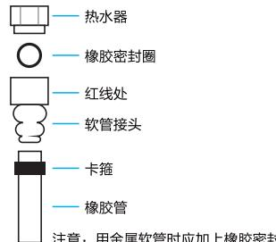
**!** 燃气管必须选择专用的橡胶管或合格的刚性管及燃气调压阀（符合GB/T10546和GB12244）；按照《技术性能参数》表中接头规格选择管的尺寸；燃气入口与软管接头间必须装上橡胶密封圈且软管必须连接到接头红线位置，并用卡箍固定好橡胶管；安装后用肥皂水检查是否有漏气现象
