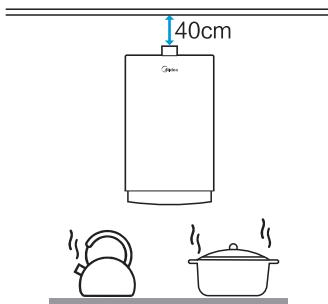
● 下方不得设置煤气烤炉、煤气灶等燃具，且不应靠近电磁炉、微波炉等强电磁辐射电器；热水器的安装位置上方不得有电力明线/电器设备/燃气管道，热水器与电器设备的水平距离应大于40cm。
