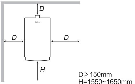
● 安装部位为不可燃材料建造，热水器周围150mm内无可燃物；若安装部位是可燃材料或难燃材料时，采用防热板隔离，防热板与墙的距离>10mm。热水器安装在距地面1.55~1.65米左右。
