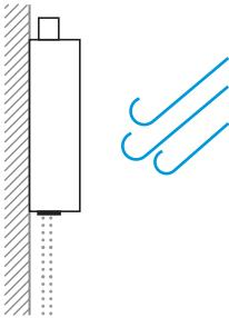
● 热水器禁止装在房屋外，不要安装在强风能吹到的地方，否则会使热水器的火焰熄灭或产生不完全燃烧。
