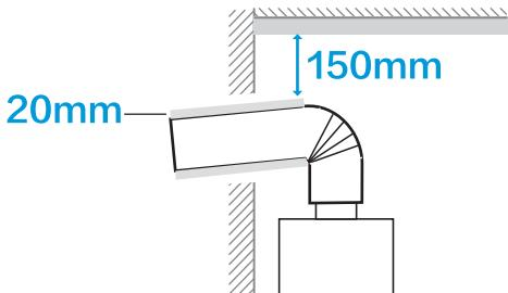
**!** 烟道通过可燃材料构成的墙壁时，必须用 $>20\text{mm}$ 厚度的绝热阻燃材料覆盖；烟道隐藏在天花板内时，用绝热材料包裹：厚度 $>20\text{mm}$ 。烟道离天花板及家具等可燃物品距离 $>150\text{mm}$
