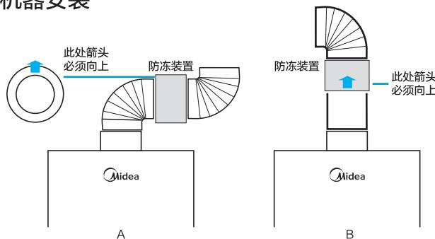
②排烟管直管总长≤3m，转弯≤2个，转弯角度>90°，以减小排烟阻力；烟道与墙壁圆孔间的间隙不得用水泥类东西填充，方便维修。带机械式防冻装置的热水器，按照上图A/B两种安装方式选其一进行安装，务必保持防冻装置底部的箭头是垂直向上(新型防冻装置只能按B方式垂直安装)
