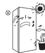
冰箱顶部空间大于20cm，两侧与墙的距离大于20cm，背部与墙的距离大于10cm，便于冰箱门的开合和热量散发，用温湿抹布将冰箱内外擦干净（温水中可加少量洗涤剂，最后用清水擦净）。
