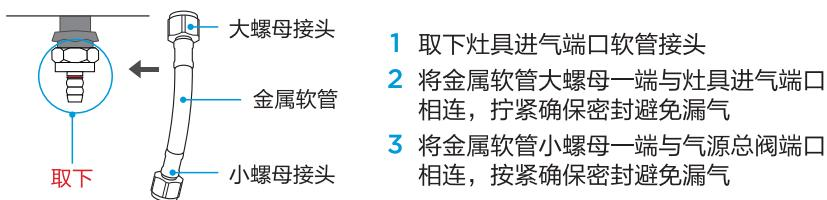
确认燃气管连接无漏气
