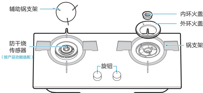
辅助锅支架放置说明：在使用小锅时，如果锅支架不能稳定放置小锅，可使用辅助锅支架。将辅助锅支架沿图示方向放置于外环火盖上（注意辅助锅支架正反方向），再把小锅放置于辅助锅支架上使用。
