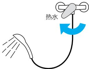
4 旋下安全阀，排完水后旋上安全阀，关闭出热水阀；安全阀内有橡胶垫圈，旋动时请适当大力一点(部分型号的安全阀形状可能与示意图有差异)
