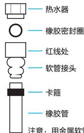
注意：用金属软管时应加上橡胶密封垫
