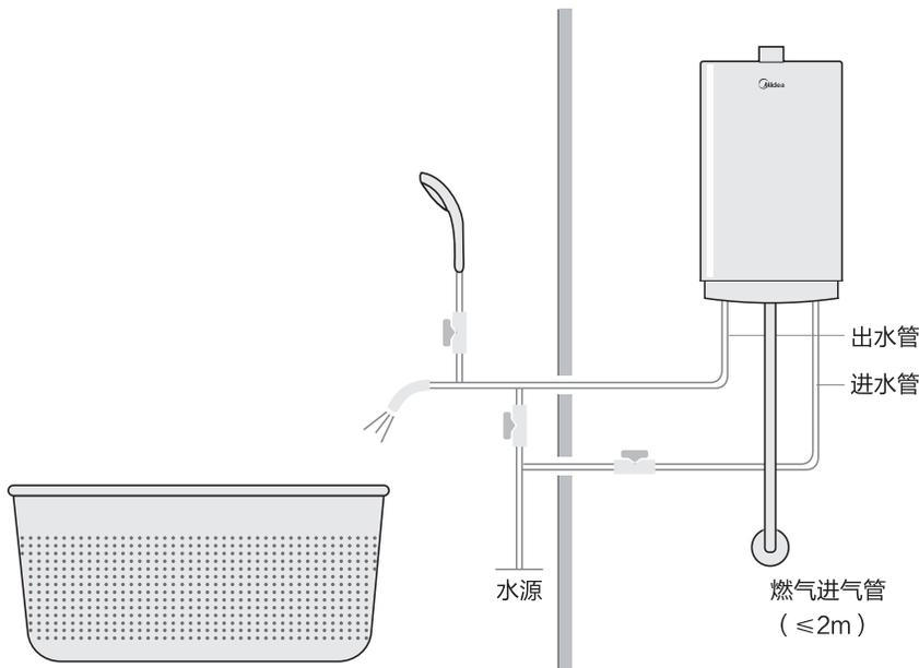
1. 在安装热水器前, 请您同当地煤气公司或燃气管理部门联系, 选择合格的燃气管, 调压阀/钢瓶/卡箍/排烟管等, 必须委托合格的专业技术工人安装。
