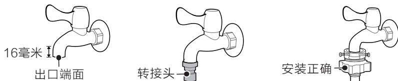
**备注：**不要直接在洗衣机专用水龙头的转接头上安装连接座。如果用户已有洗衣机专用水龙头，为防止脱落漏水，请拧下转接头后，再按照如下正确的方式连接进水管与水龙头。
