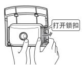
●安装的方法 将盒子的别扣插入盖子 的小孔中,关牢锁扣
