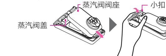
● 当盖内侧的蒸汽阀密封筋发生脱出时，请压入，使其不从槽中露出。
