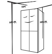
冰箱顶部空间大于30cm，两侧及背部与墙的距离大于10cm，便于冰箱门的开合和热量散发，用温湿抹布将冰箱内外擦干净（温水中可加少量洗涤剂，最后用清水擦净）。
