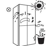
远离热源，避免阳光直射。勿放置在潮湿或有水的地方，防止生锈或削弱绝缘效果。
