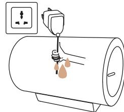
🚫 禁用移动插座、破损电源线和插座；禁止湿手碰触插头、插座、遥控器，以防触电；禁止带电安装或维修
