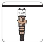
热水器排完水，握住旋钮向右旋转90°，右旋转90°后，等观察排水管没有水流时即可取下排水管，若阀门未关闭到位排水管是取不下来的，需再次向右旋转至排水管可以轻易拿下为止
