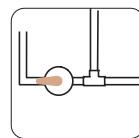
打开混水阀到热水端泄压
