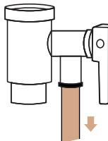
⚠ 如果电热水器内部压力过高，水可以从单向安全阀的泄水软管处流出，属正常保护。该泄水软管应安装在无霜的环境中，向下垂直，同时保持与大气相通
