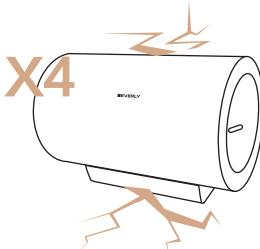
! 墙壁需承受电热水器注满水后四倍以上的重量才可安装，否则采取其他加强措施
