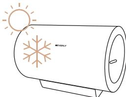
🚫 严禁将电热水器安装在室外；禁止将电热水器安装在高温物体和阳光直射附近；禁止安装在有结冰风险的区域
