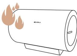
🚫 禁止在电热水器附近放置易燃易爆物品
