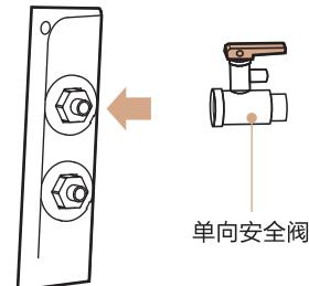
③ 注意保持单向安全阀泄压孔朝下，以保证水能从泄压孔中顺利流出，连接到单向安全阀的泄水软管要连续向下倾斜安装在无霜的环境中，并且必须保持与大气相通，切勿堵塞，并定期动作压力释放装置，以去掉碳酸钙沉积并证明装置没有堵塞。
