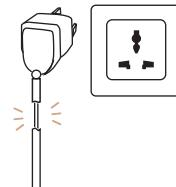
🚫 切断电源时，请勿直接拉拔电源线，以防拉断，如果电源软线损坏，为避免危险，必须由我公司专职人员来更换
