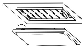
2) 安装面罩：将面罩放入边框，然后将边框套到底盘上，旋转卡扣将边框固定在底盘上，完成安装。
