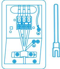
1. 电源线使用U型舌压接，防止脱落。
