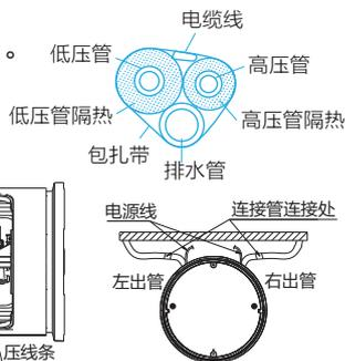
1. 将连接管直平铺在地板上—将排水管、各种电缆线（必须将两端的插接端口整理正确）铺在连接管周围。
