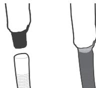
备注：对接排水管时，排水管在外层，套入室内机排水管，用力使两管接触面套到尽头。
