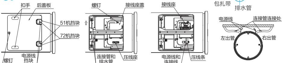
1. 将连接管直平铺在地板上—将排水管、各种电缆线（必须将两端的插接端口整理正确）铺在连接管周围。
