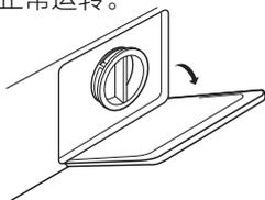
1 拔掉电源插头, 打开过滤器门
