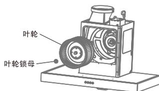
5 用软刷沾中性清洁剂将叶轮、蜗壳清洗干净,最后依拆卸的相反次序安装好
