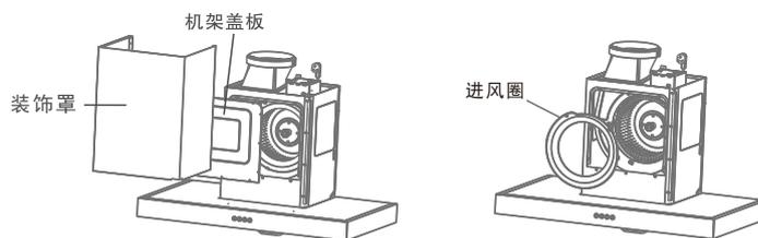
4 按指示方向把叶轮锁母旋下,沿电机轴方向取出叶轮
