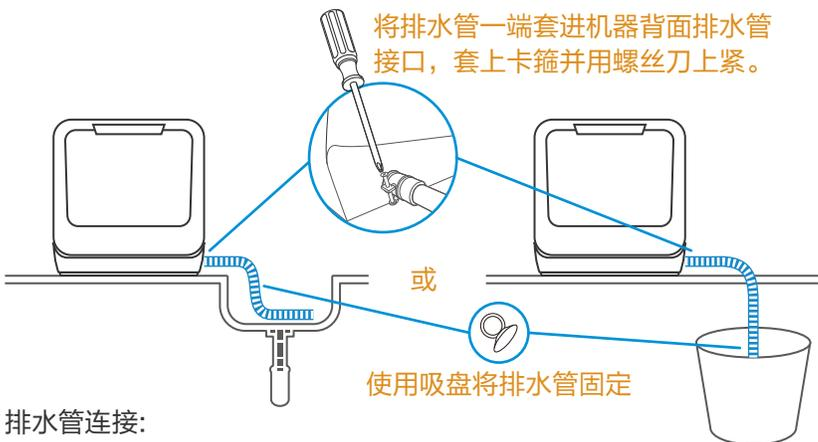
将排水管一端套进机器背面排水管接口，套上卡箍并用螺丝刀上紧。
