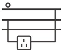
洗碗机必须接地线，在出现故障和损坏时，地线由于其极低电阻几乎可以将全部电流分流，从而有限的保护您免受触电伤害。
