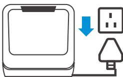
在维修、清洗机器或长期不使用时必须拔掉电源插头。
