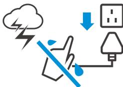
如遇雷雨天气，需断开电源，避免雷击导致洗碗机受损。请不要用湿手触碰电源线，以免触电。
