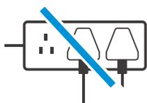
禁止擅自更换电源线，或将电源线中途驳接或与其他电器并联使用。擅自更换、中途驳接、超负荷使用均有可能导致触电或引起火灾。如电源线有损坏，请委托当地经销商或服务网点进行维修。
