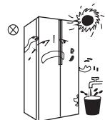
远离热源，避免阳光直射。勿放置在潮湿或有水的地方，防止生锈或削弱绝缘效果。
