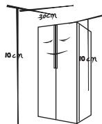
冰箱顶部空间大于30cm，两侧及背部与墙的距离大于10cm，便于冰箱门的开合和热量散发，用温湿抹布将冰箱内外擦干净（温水中可加少量洗涤剂，最后用清水擦净）。
