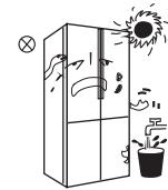
远离热源，避免阳光直射。勿放置在潮湿或有水的地方，防止生锈或削弱绝缘效果。
