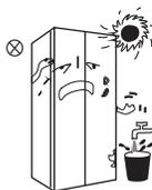
远离热源，避免阳光直射。勿放置在潮湿或有水的地方，防止生锈或削弱绝缘效果。
