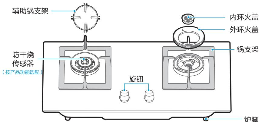
辅助锅支架放置说明：在使用小锅时，如果锅支架不能稳定放置小锅，可使用辅助锅支架。将辅助锅支架沿图示方向放置于锅支架上（注意辅助锅支架正反方向），再把小锅放置于辅助锅支架上使用。
