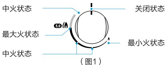
**点火** 打开气源，按压灶具旋钮并按逆时针方向旋转
