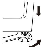
注意:调平洗衣机可以减少噪音和震动，请务必在使用前将洗衣机调平。
