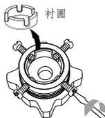
旋松四颗螺钉，将连接座套在水龙头上，均匀拧紧螺钉
