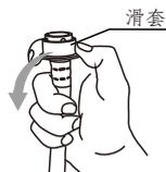
下压滑套，将进水管插入连接座
