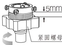
旋松紧固螺母，使螺纹露出约5毫米
