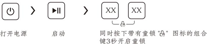
注意：设定“童锁功能”后，按任何键（除电源开关键外）都不能对洗衣机进行操作。如果想要操作洗衣机，请先将“童锁功能”解除后再进行（在童锁功能启用状态下，同时按下童锁组合键3秒以上，可以解除“童锁功能”）。
