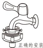
注意：不要直接在洗衣机专用水龙头的转接头上安装连接座。如果用户已有洗衣机专用水龙头，为防止脱落漏水，请拧下转接头后，再按照下列图示方法连接进水管和水龙头。
