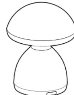
■ 使用过程中，若拔掉外电切换内部电池供电时，灯光会灭一下再恢复亮灯。
