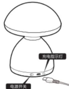
■ 充电时，充电指示灯亮起，充满电后，指示灯熄灭。
