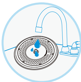
② 清洗盖板及密封圈，并用抹布擦干。
