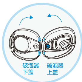
⑤ 将浮子顶杆放入破泡器上盖，再将破泡器上下盖的扣位对齐，重新合上破泡器。
