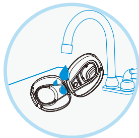
④ 清洗破泡器内、外部，并用抹布擦干。注意将浮子顶杆放好。
