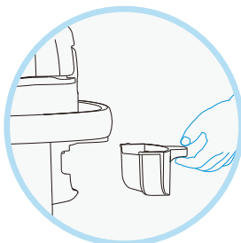
① 用手握住储水盒水平向外拉出，小心用力过猛，以免水洒落。 储水盒应经常清洗，以防产生异味。
