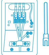
1. 电源线使用U型舌压接，防止脱落。
