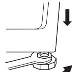
注意：调平洗衣机可以减少噪音和震动，请务必在使用前将洗衣机调平。
