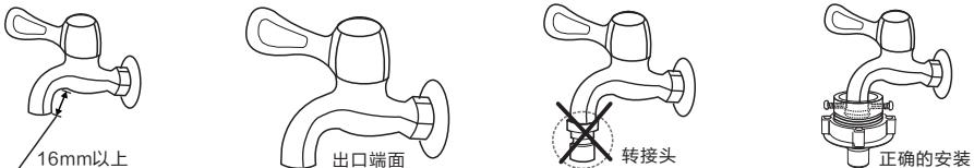
注意：不要直接在洗衣机专用水龙头的转接头上安装连接座。如果用户已有洗衣机专用水龙头，为防止脱落漏水，请拧下转接头后，再按照下列图示方法连接进水管和水龙头。
