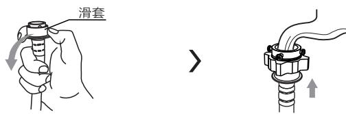
下压滑套，将进水管插入连接座
