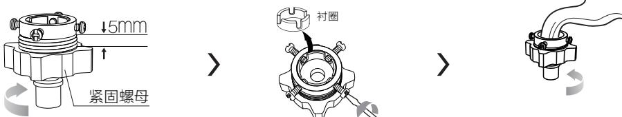
旋松紧固螺母，使螺纹露出约5毫米
